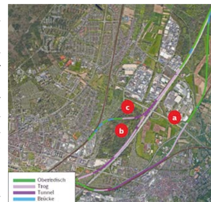
Abb. 3: Linienvarianten im Osten von Karlsruhe, Quelle: DB
